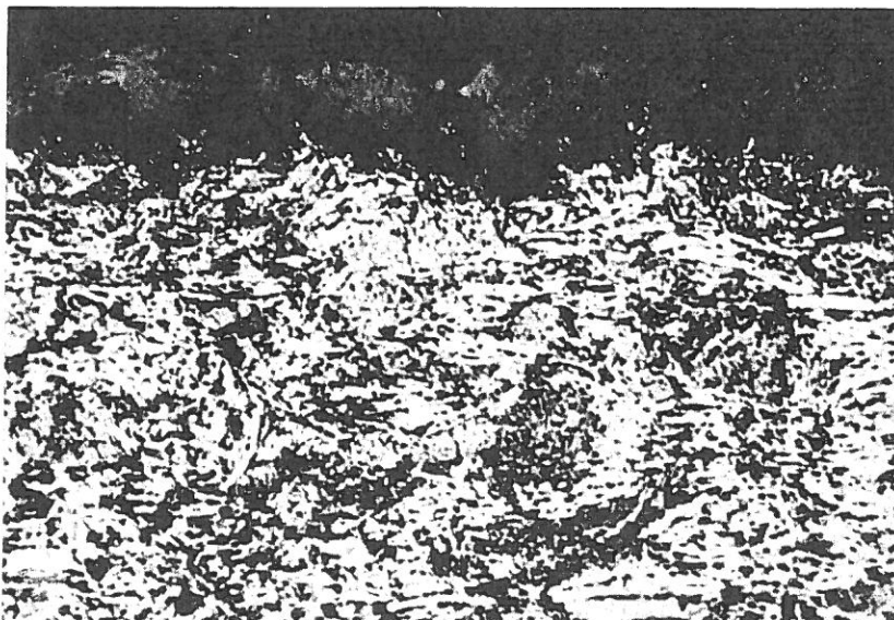
Bild 33: Mikrostruktur der Schicht aus WSe 2 -Ga (10 Gew.-%) mit oxidischer Oberflächenschutzschicht nach Auslagerung bei 600°C an Luft (Vergrößerung 1000 x).
