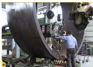
Schweißen der Ringsegmente
