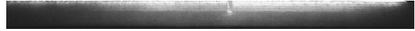
Abbildung 3b. untere Seitenansicht vom Nutprobekörper nach Zugbelastung mit seitlicher Beleuchtung, erkennbar ist die eigentliche Nut sowie eine seitlich begrenzte Front in der Ebene des Nutbodens
