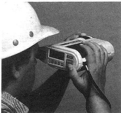
IR-Strahlungsthermometer von Ircan im Einsatz
