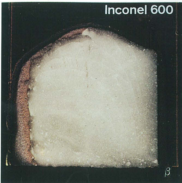
Bild 2.2-7 Lötlung von Inconel-Blech 0,1 mm auf \text{Al}_2\text{O}_3 . Das Blech ist im Lötbereich //// infolge der \alpha_{\text{Th}} -Differenz beim Abkühlen verformt worden ( \alpha ) und dann abgeplatzt ( \beta, \gamma ). Am abgeplatzen Blech hängt noch die ausgebrochene Keramik ( \beta ).
