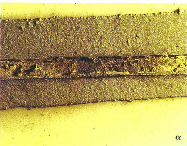
Bild 2.2-5 Bruchbild einer Lötprobe gemäß Bild 2.2-1,2. Hier: Bruch durch Nachgeben der Lötung bei 900°C innerhalb von 24 h. Der Bruch erfolgt im oberflächennahen Lotmaterial. Das Lot ist im Bereich der Bruchfläche braun-gelb-farbig, außerhalb im Bereich des Luftzutritts violett-farbig.
