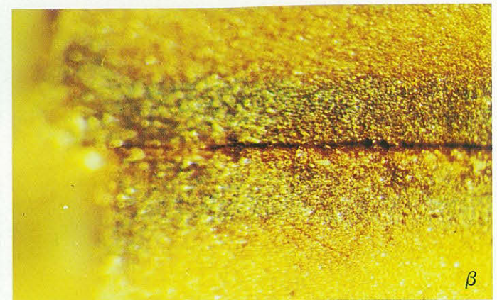
Bild 2.2-14 Vergleich der ungealterten (α) und der bei ca. 950° C gealterten (β) Probe \text{Al}_2\text{O}_3/\text{Al}_2\text{O}_3 .
