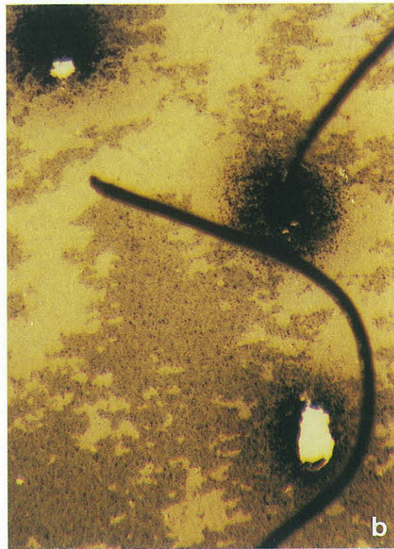
Bild 2.4-10 Bondtestplatte bei Durchlicht. Dunkle Punkte: Bondbereich Helle Punkte: Mit der Sputterschicht ausgerissene Bonds.
