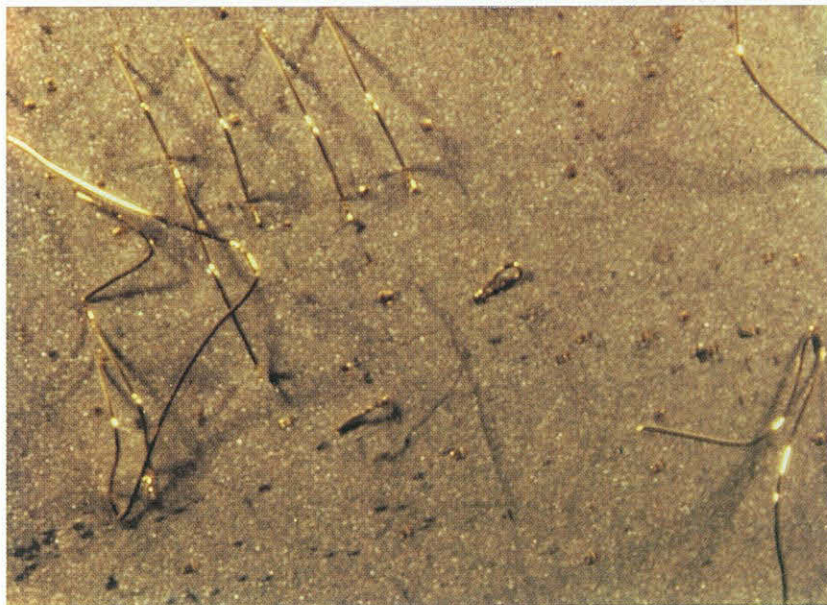
Bild 2.4-7 Aufgerissene Loops auf einer mit Platin besputterten \text{Al}_2\text{O}_3 - Keramik.
