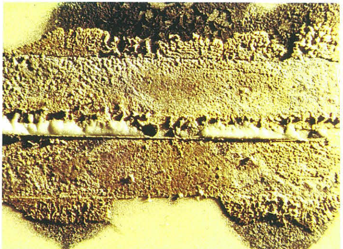
Bild 2.2-4 Bruchbild einer Lötprobe gemäß Bild 2.2-1,2. Hier: Bruch durch Überlastung bei 850°C. Der Bruch erfolgt in der Keramik
