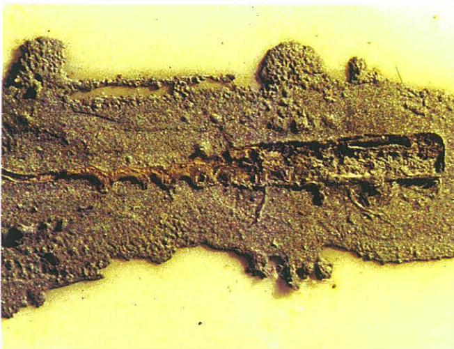
Bild 2.2-3 Bruchbild einer Probe mit schlechter Lötung: links ist eine Lotverarmung durch Lotausfließen infolge des starken Benetzungsbestrebens eingetreten
