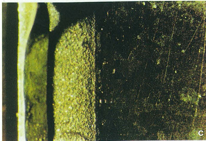
Bild 2.3-6 Al 2 O 3 -Plättchen-Platinblechverbund aus einem Aufnehmer des Typs Cerl-Planer nach ca. 2000 h bei 550 °C. a) Prinzipielle Anordnung b) Seitenansicht c) Draufsicht nach Entfernung des Al 2 O 3 -Plättchens
