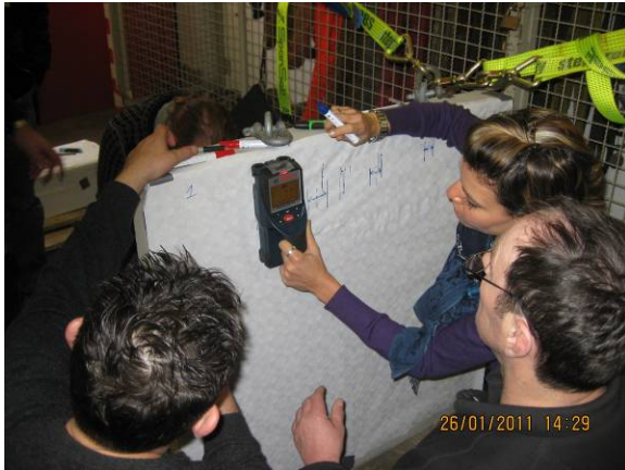
(a) Abbildung 4 (a) Einzeichnen der detektierten Bewehrung; (b) Ergebnis der Bewehrungsartung mit „Schriftbild“ nach Verfahrensanweisung.
