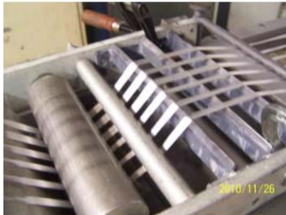
Bild 2: Glasfasern werden über drei scharfe Kanten gezogen
