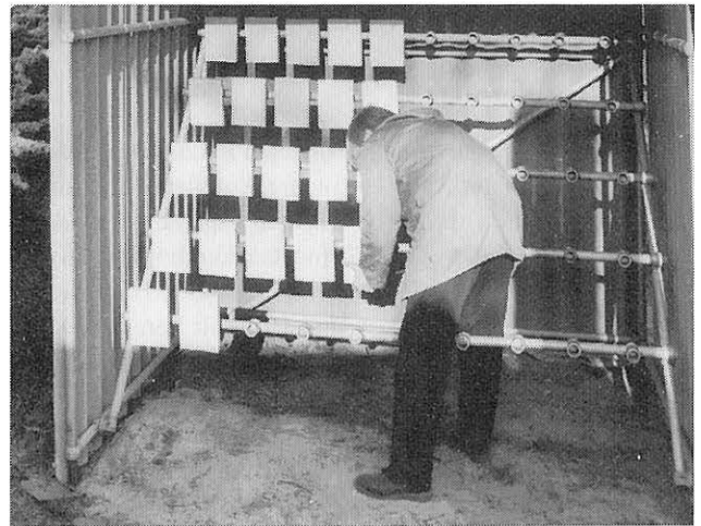
Bild 4: Gestell für die Freibewitterung von Putzmörteln
