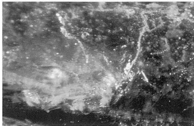
Bild 29: Fahnenträger VI 81a, oberer Fahnenbereich (rückseitig) in Nähe der Fahnenstange; Grüne Kristalle wachsen in unmittelbarer Umgebung von opak-grünen Stellen des an nähernd bis zum Au-Träger ausgebrochenen grünen Emails; 54fache Vergrößerung
