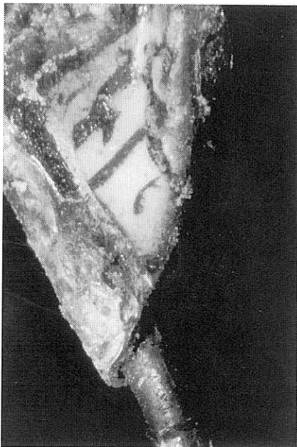
Bild 27: Fahnenträger VI 81a, Fahnenspitze (vorderseitig); Grüne Kristalle wachsen aus dem Riß, welcher in den Träger des Emails reicht. 16fache Vergrößerung
