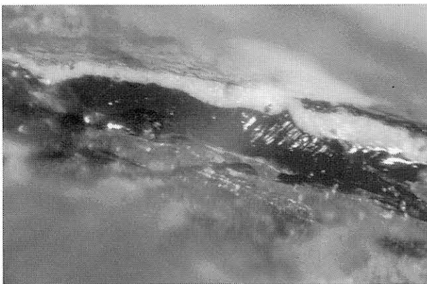
Bild 9: Fahnenträger VI 81a, Wappen auf der Fahnerrückseite; Querschnitt des Maleremails in mehreren Schichten: Au-Träger/transluzides, grünes Grundemail/opak-weißes Maleremail/opak-polychrome Lasuren; 56fache Vergrößerung
