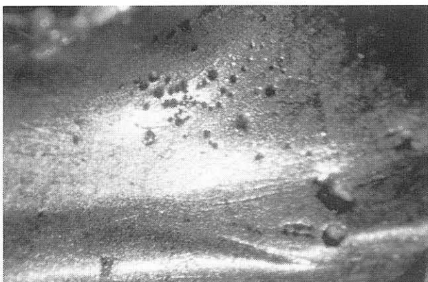
Bild 5: Drache VI 83n, Gußporen unterhalb der rechten Rachenseite; 40fache Vergrößerung
