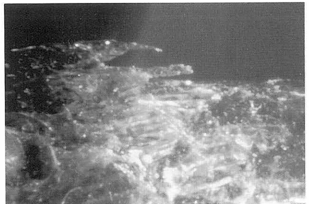
Bild 24: Drache VI 83n, Schwanzansatz (rechts); Das Email steht weit vom Träger ab. 25fache
