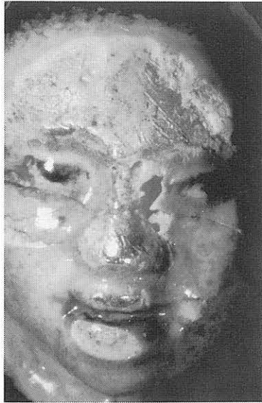
Bild 7: Schirmträger des Moguls VIII 204, Kopfansicht (frontal); Scharierung des Rezipienten zur Hafterhöhung des Emails; 18fache Vergrößerung
