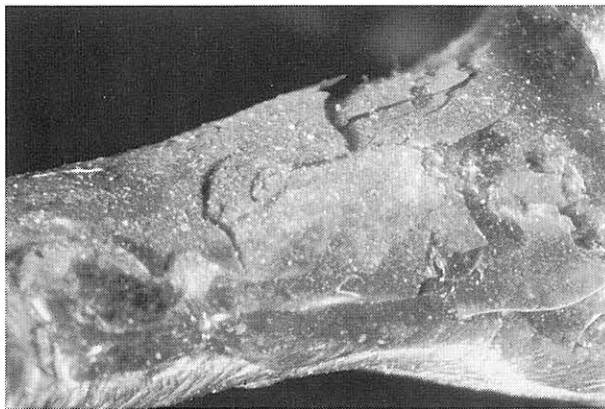
Bild 22: Drache VI 83n,, linker Vorderfuß; Abspreizen der grünen Emailschuppen; 18fache Vergrößerung
