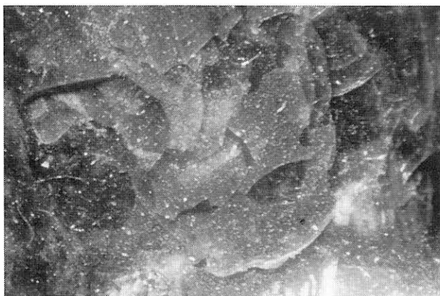
Bild 23: Drache VI 83n, Halsoberseite (rechts); Die Schichten-trennung erfolgt auch quer durch das benachbarte gelbe Email. 23fache Vergrößerung
