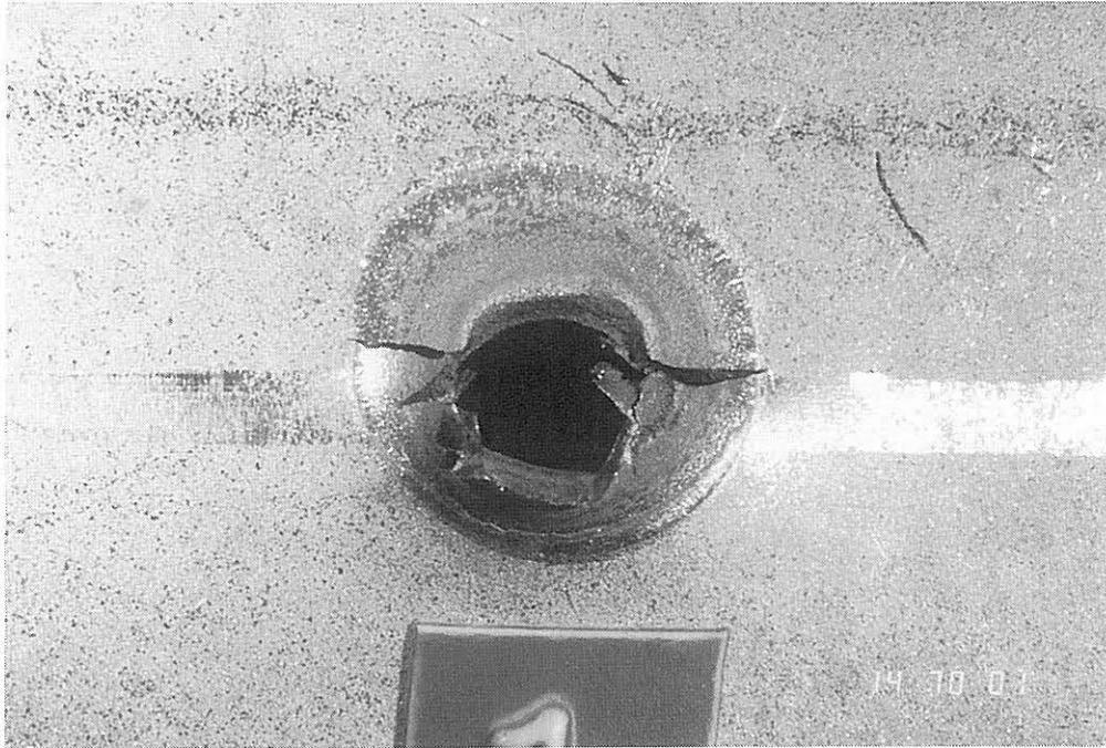
*Bild A-23: Vergrößerung des Punktes Nr. 1 aus Bild A-22, U-Seite, Ausknöpfbruch*
