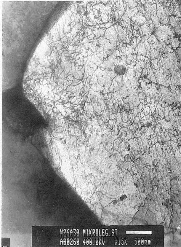
*Bild A-56: Subgefüge im Nb-mikrolegierten Stahl.
