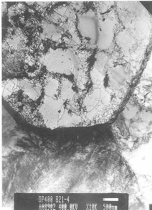
*Bild A-41: Deformierte Zellen in DP400,  $\epsilon_a = 0,2\%$ ,  $N = 43.001$ ,  $N/N_A = 62\%$*
