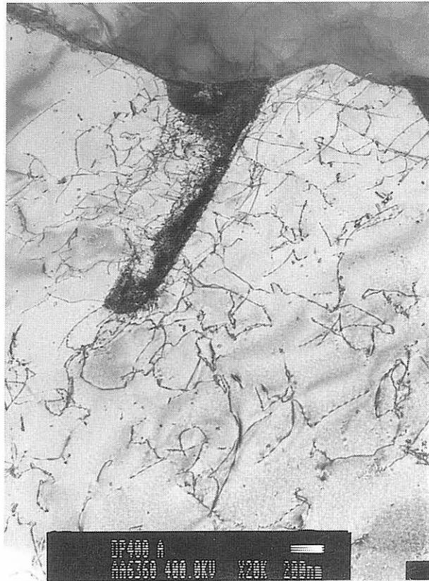
*Bild A-50: Substruktur in DP500, Anlieferungszustand*
