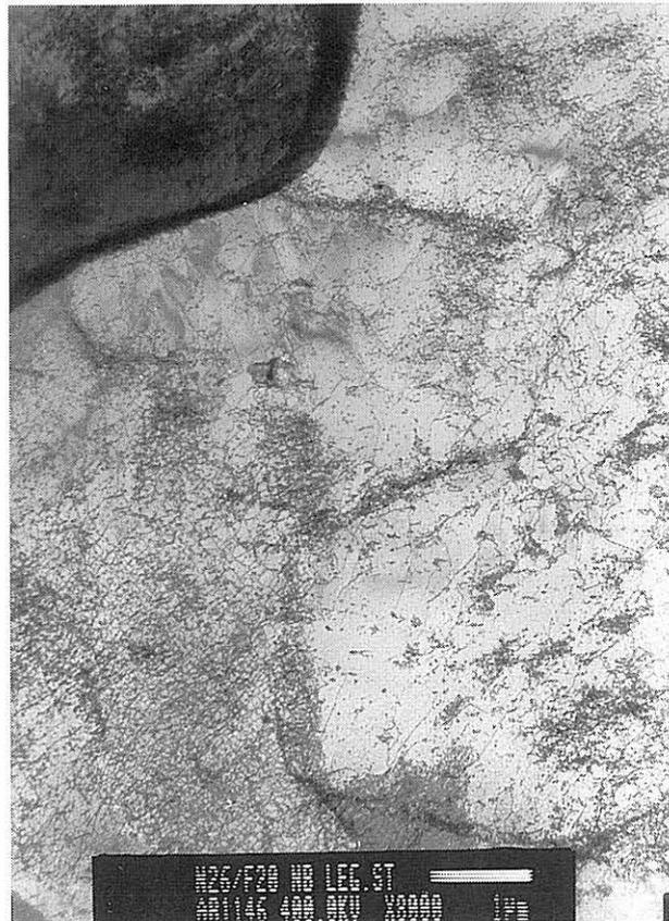
*Bild A-59: Subgefüge im Nb-mikrolegierten Stahl,
