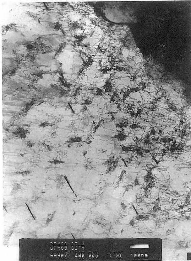
*Bild A-43: Behinderung der Bildung von Zellstrukturen in DP400,  $\varepsilon_a = 1,0\%$ ,  $N = 11$ ,  $N/N_A = 4\%$*
