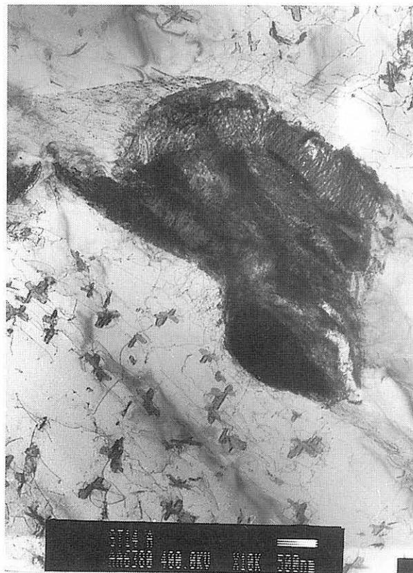
*Bild A-33: Subgefüge in DP400, Anlieferungszustand*
