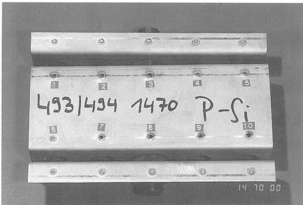
*Bild A-22: Übersichtsaufnahme Kopfzugprobe K-P 10x5-1,5/1,0, P-Si-Stahl, nach dem Auftreten von Ermüdungsrissen bis zur Bruchkraft belastet*
