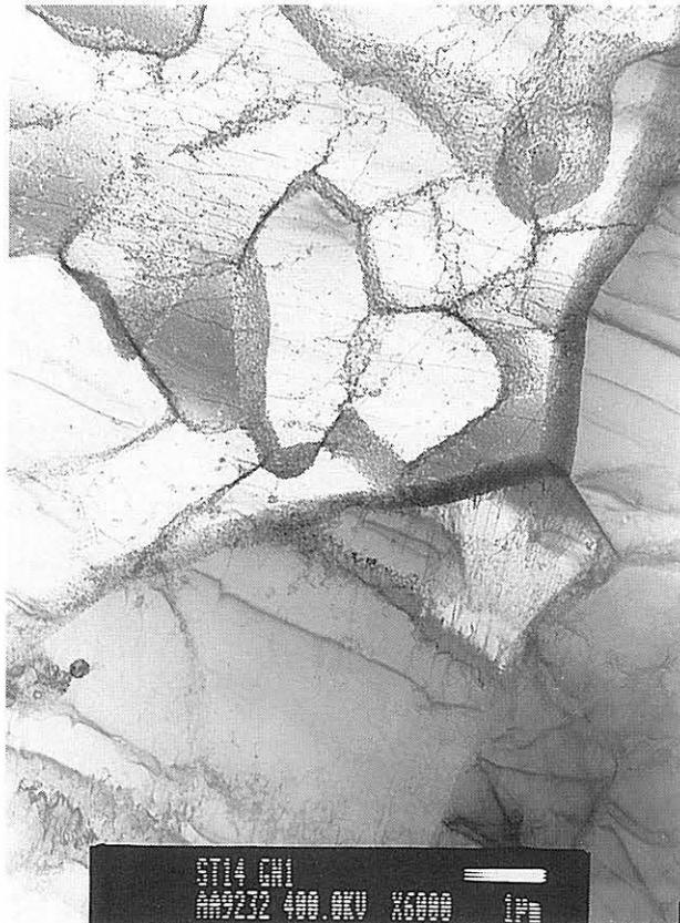
*Bild A-28: Zellstrukturen in FeP04,  $\epsilon_a = 0,12\%$ ,
