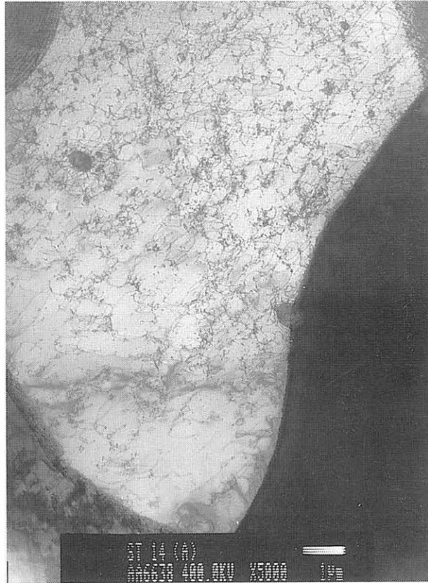
*Bild A-25: Subgefüge von FeP04, Anlieferungszustand*
