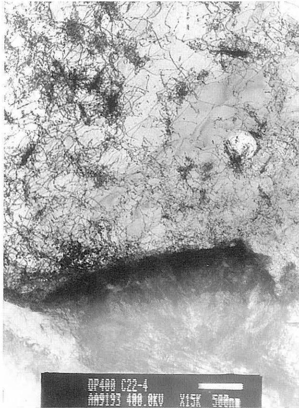
*Bild A-48: Unvollständige Zellstrukturen in DP400,
