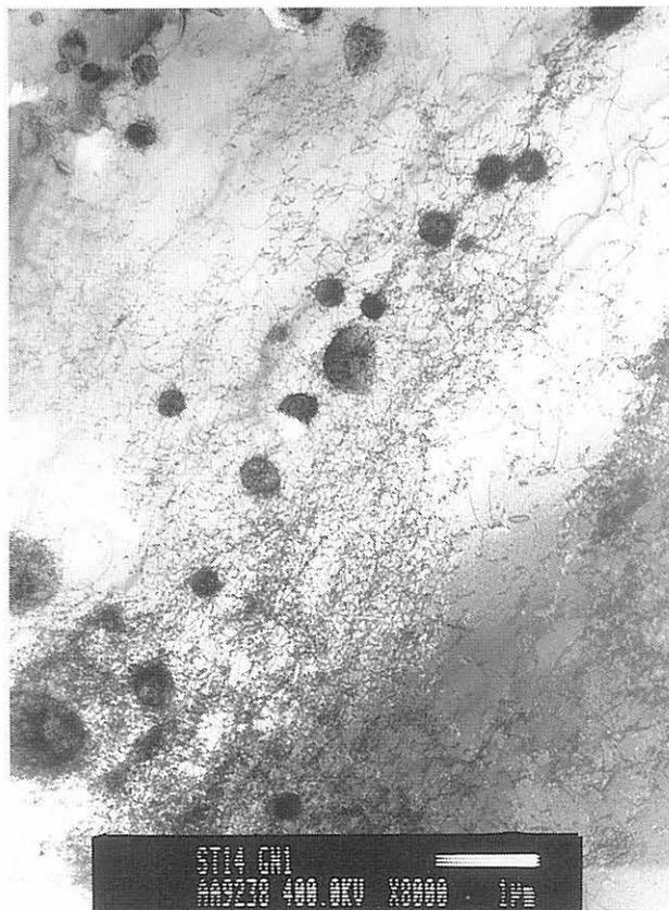
*Bild A-29: Subgefüge von FeP04,  $\epsilon_a = 0,12\%$ ,
