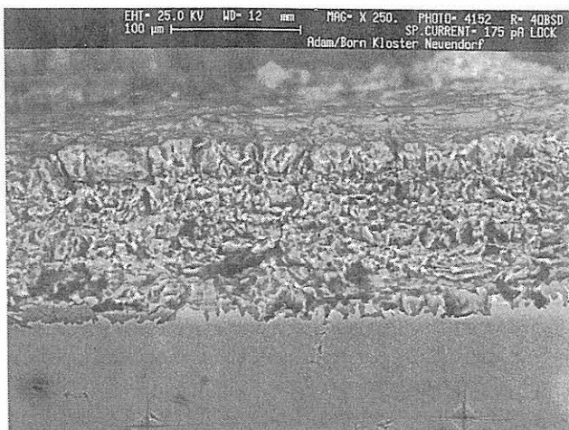
Abb. 28: Rasterelektronenmikroskopische Aufnahme des Querschnitts durch die Oberfläche einer mittelalterlichen Glasprobe; Ausgangszustand vor der Reinigung
