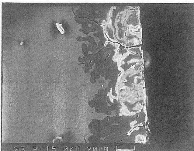
Abb. 4: Materialkontrast Oberflächenabbildung mit Rückstreuelektronen; Glas mit Gelschicht (dunkel), in die Gelschicht sind Korrosionsprodukte aus Schwarzlot immigriert (hell)
