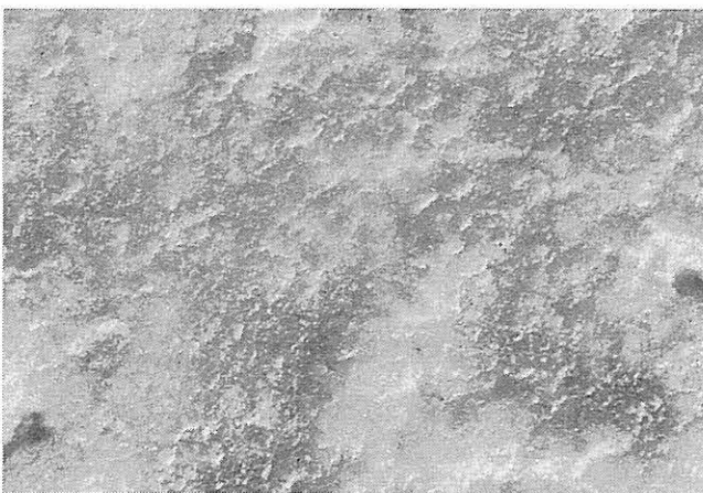
Abb. 31: Oberfläche einer Glasprobe aus der Katharinenkirche Oppenheim nach Reinigungsvariante 1; 50fache Vergrößerung
