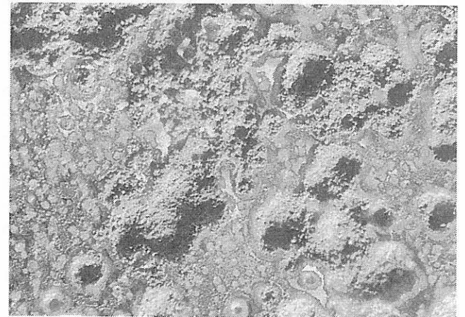
Abb. 71: wie Abb. 66, jedoch nach 12h Behandlung mit optimierter EDTA-Kompresse, 25fache Vergrößerung
