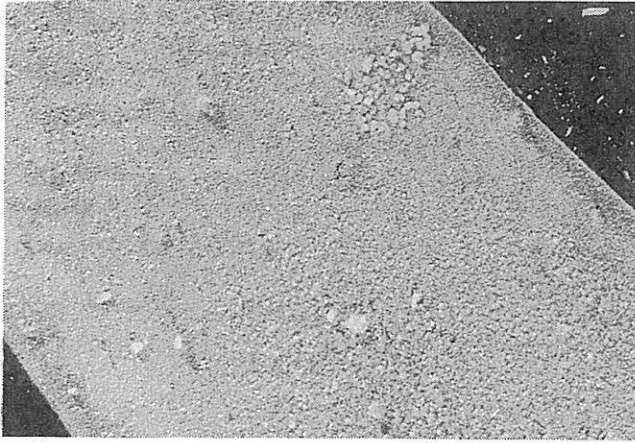
Abb. 103: Mit Wachs gefestigte lockere Schwarzlotkontur (Versuch Nr. 38, Tabelle A1 im Anhang 2) nach Bewitterung im Klimaschrank; Korrosionsprodukte haben die dünne Wachsschicht durchdrungen; 25fache Vergrößerung
