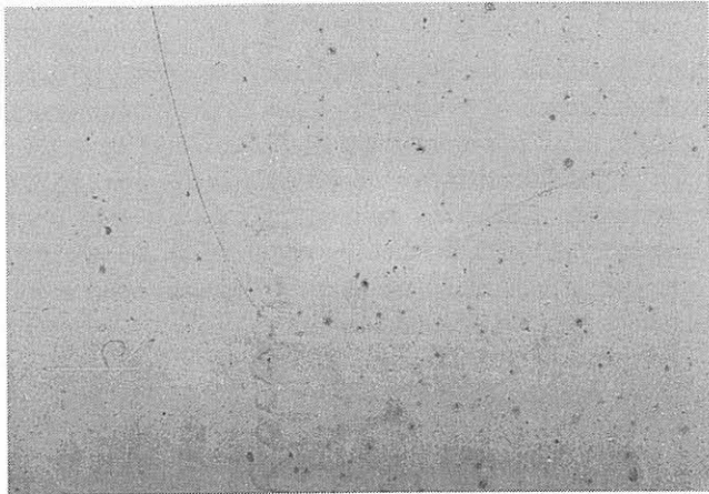
Abb. 93: Oberfläche eines Sol/Gel-beschichteten Objektträgerglases nach der ersten Beschichtungsstufe, 50fache Vergrößerung
