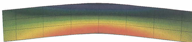
Abb. 4.91 Spannungsverteilung im Bereich der Schweißnaht System WELDSC: Schweißnaht innen und außen beschliffen, Studie des zusätzlichen Effektes durch Glättung der Außenoberfläche
