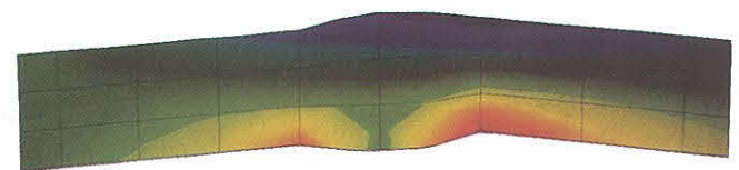
Abb. 4.121 Spannungsverteilung im Bereich der Schweißnaht System WELDSF: Schweißnaht-Verziehung innen zur Kompensierung eines angenommenen Axialversatzes v.l.n.r. aufwärts
