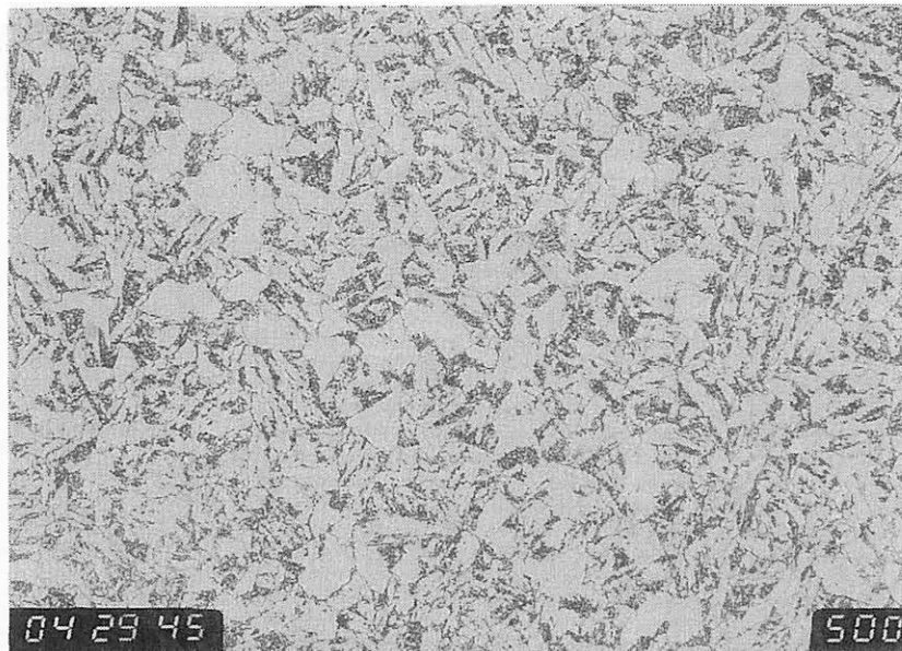
Bild 8-3: Gefüge des 22NiMoCr3-7 – höherer Anteil an polygonalem Ferrit (ca. 12 Vol %) in der Mitte der Behälterwand, L-S-Ebene, Nital geätzt, V= 500:1
