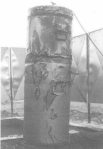
Abb. 72 18B-Behälter nach gesteigertem Brand- versuch (75 min)
