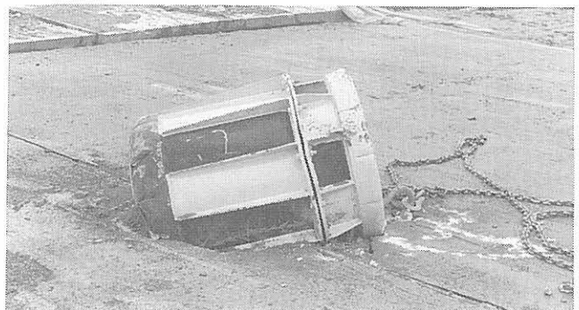
Abb. 69 BRECO-Behälter nach 200 m-Abwurf auf Betondecke
