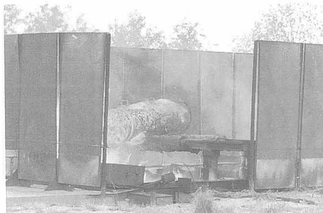
Abb. 76 Mechanisch vorbeanspruchter 18B-Behälter nach 30 min-Brandversuch
