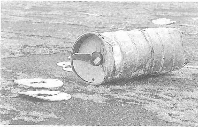
Abb. 52 6M5-Container nach 200 m-Abwurf
