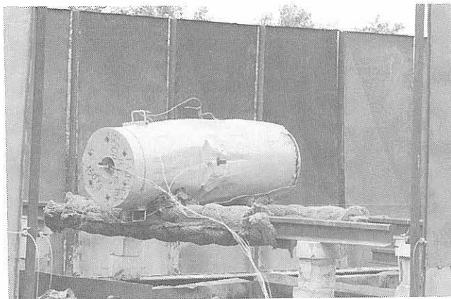
Abb. 75 Mechanisch vorbeanspruchter 18B-Behälter(200 m-Abwurf) vor 30 min-Brandversuch
