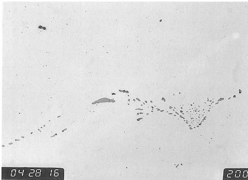
Bild 7-7 : Gefüge des 17MoV8-4, Inseln zusammengelagerter Mangansulfide T-L-Ebene, ungeätzt, V= 200:1
