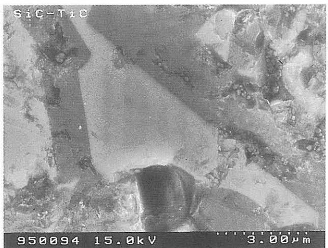
Abb. 10 REM-Aufnahme des Werkstoffs GPS-SiC-TiC, die helleren Körner sind die TiC-Phase, die dunkleren die SiC-Phase
