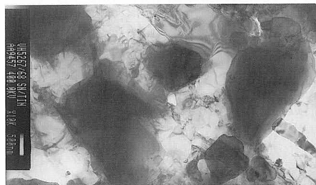
Abb. 4 TEM-Aufnahme des Werkstoffs GPS- \text{Si}_3\text{N}_4 -TiN. Die dunklen großen Körner sind die TiN-Phase
