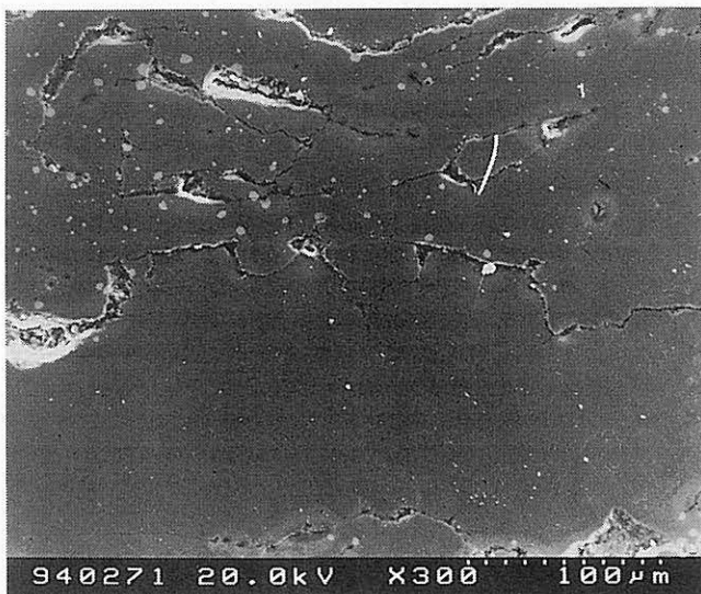
Abb. 35 REM-Aufnahme einer grob gehonten Probe nach der Wälzbelastung in Wasser
