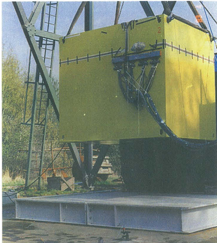
Bild 3: Gußcontainer Typ VI mit Versuchsfundament
