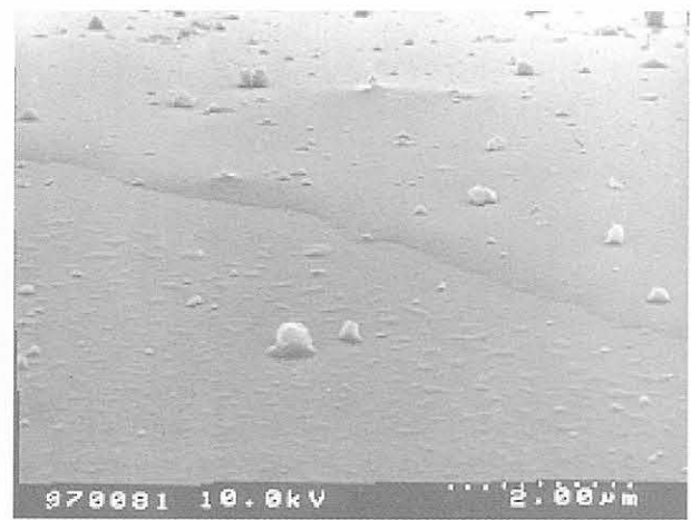
Bild 5.10: Oberfläche einer 90 min im Sauerstoffplasma geätzten optischen Glasfaser, behandelt mit BHN-Silan der Konzentration 1,0 %.
