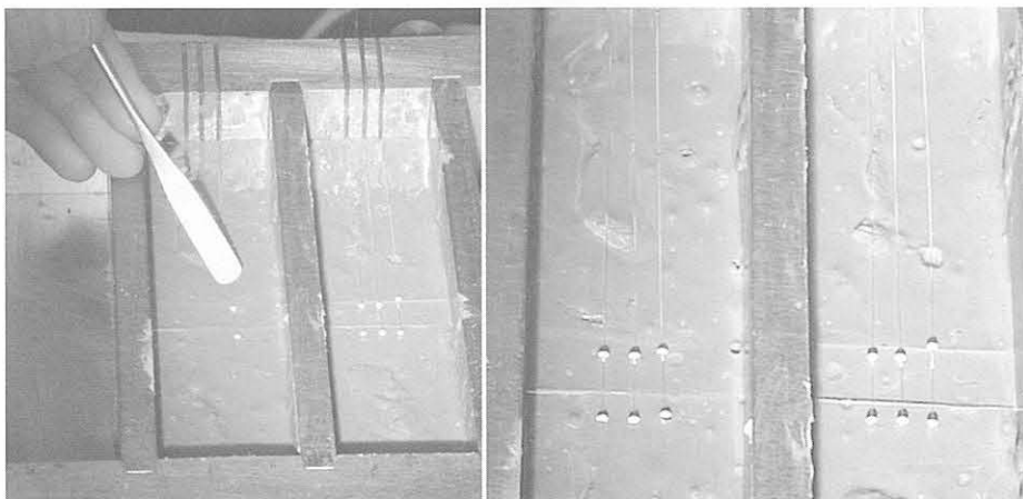
Bild 8.5: EFPI-Sensoren während der Einbettung in ein Normprisma (4 cm x 4 cm x 16 cm).
