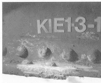
Bild 25: Rissidentifikation mit Hilfe der Magnetpulvermethode, Riss ohne Last
