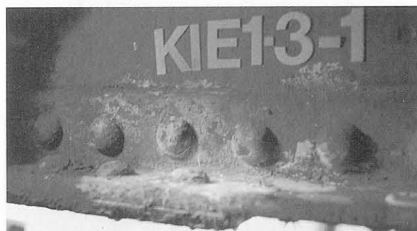
Bild 25: Rissidentifikation mit Hilfe der Magnetpulvermethode, Riss ohne Last
