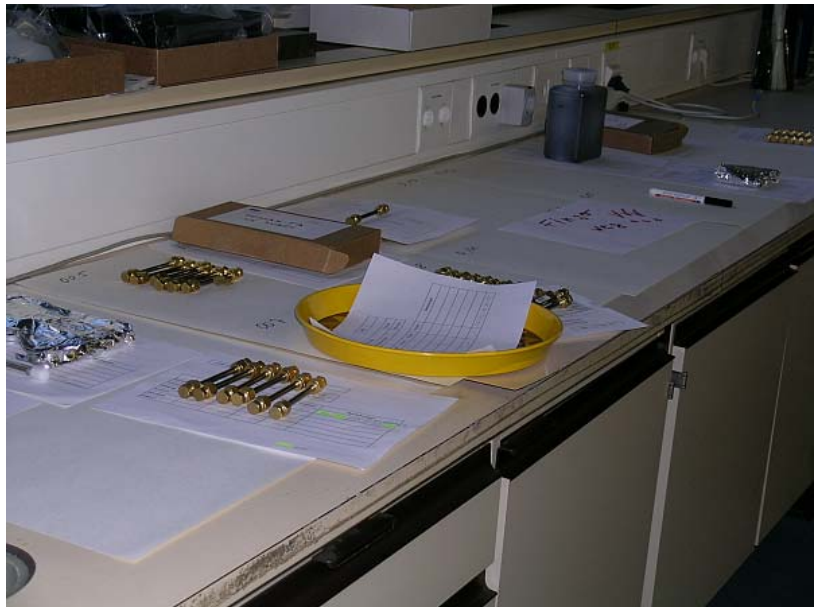
Abbildung 24: Sortierung der Probenahmerohre vor bzw. nach der Probenahme.
