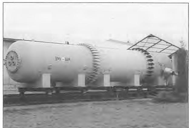
Bild 5.3: Vollständiger explosionsdruckfester Versuchstank (Segmente A, B und C)
