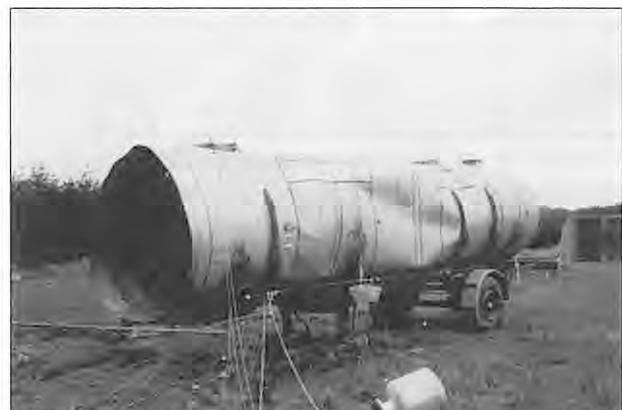
Bild 4.3: Versuchstank nach dem Explosionsdruckstoßversuch
