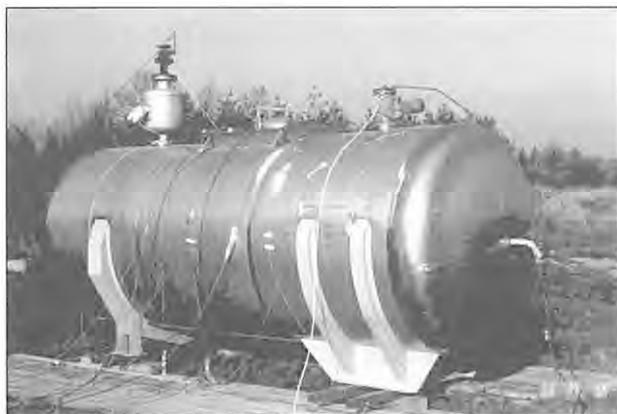
Bild 4.1: Versuchstank vor dem Explosionsdruckstoßversuch
