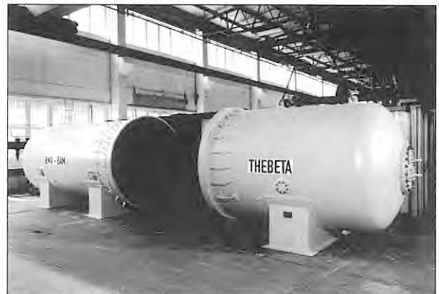
Bild 5.2: Explosionsdruckfester Versuchstank (Segmente A und C)
