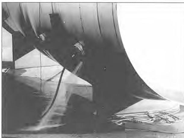
Bild 8.3: Tankversagen im Flanschbereich bei 15,5 bar
