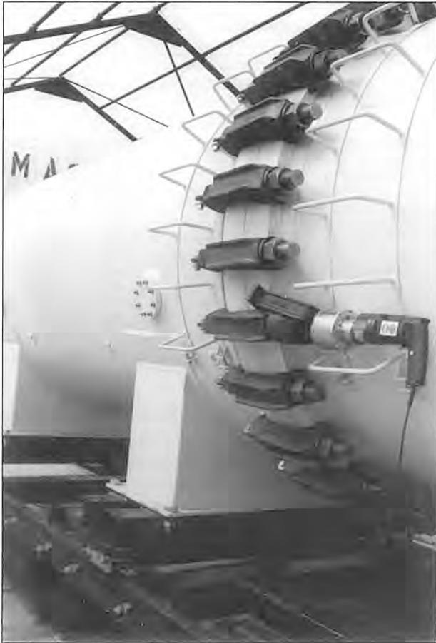
Bild 5.8: Anziehen der Klammerschrauben
