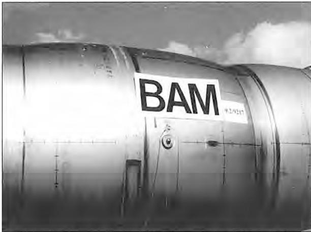
Bild 8.5: Tank nach dem Innendruckversuch (15,5 bar/11 % Manteldehnung)
