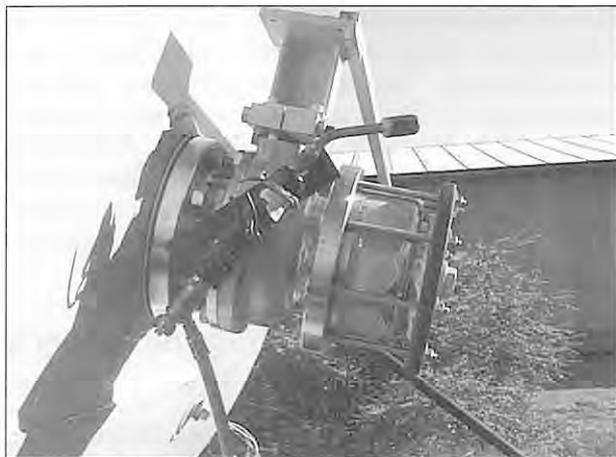
Bild 7.6: Zündbrennerposition am Versuchsaufbau vor Versuch Nr. 51 (Seitenansicht)
