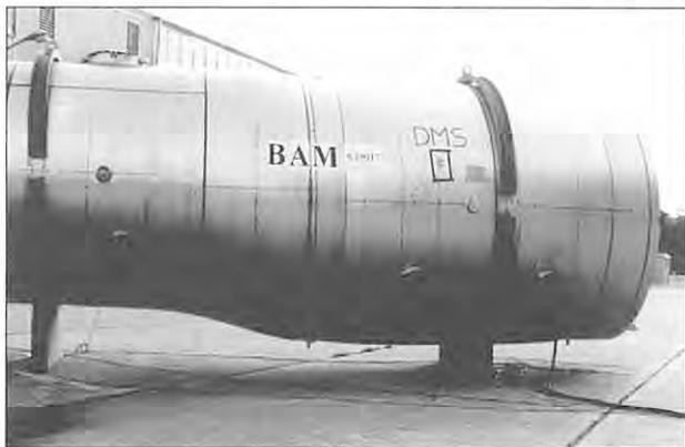
Bild 8.1: Versuchstank vor dem Wasserdruckversuch
