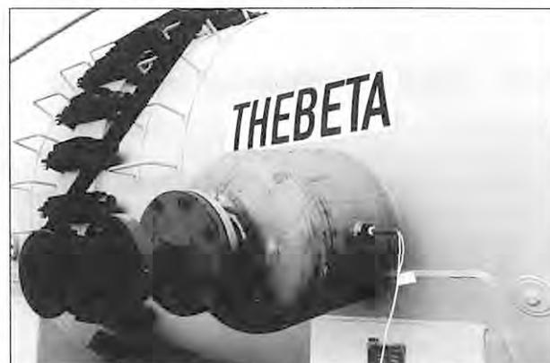
Bild 5.11: Versuchsbehälter mit angeflanschem Zündtopf
