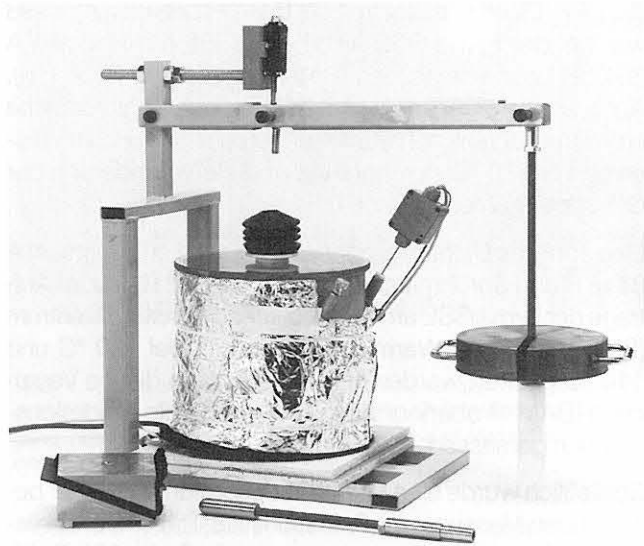
Abb. 2.2: Prüfvorrichtung für den Zeitstand-Scherversuch
