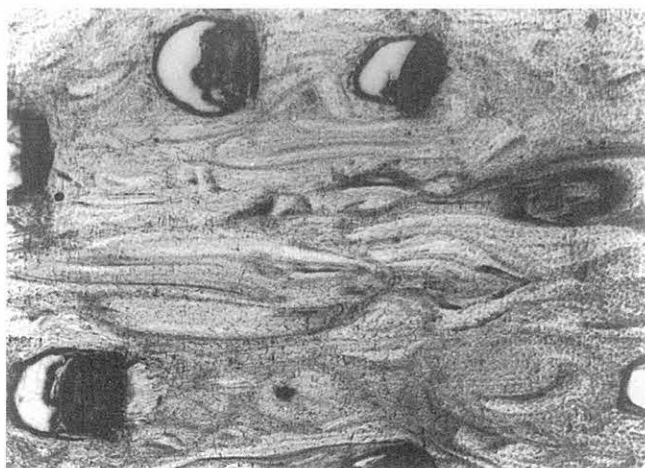
Abb. 1.3: Vergrößerte Aufnahme eines Dünnschnitts von einem "Materialklumpen" aus Strukturmaterial, das beim Sprühen durch Zugabe eines Rußbatch schwarz eingefärbt wurde. Die Breite des Bildes entspricht 1,2 mm und die Höhe 0,9 mm, die Vergrößerung beträgt also etwa 70:1.
