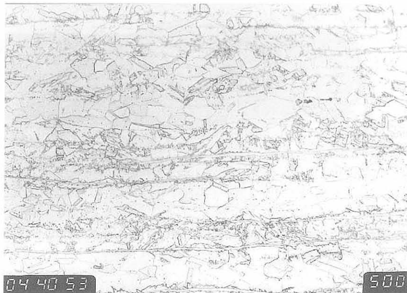
Bild 5-22: Grundwerkstoffgefüge 1.4541, Längsschliff, 500 : 1
