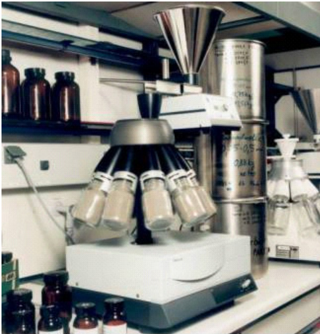
Abb. 8 Rotierender Probenteiler (8 Fallrohre)
