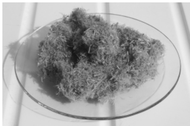
Abb. 5 Faseragglomerat als Abfallprodukt bei der Siebfractionierung
