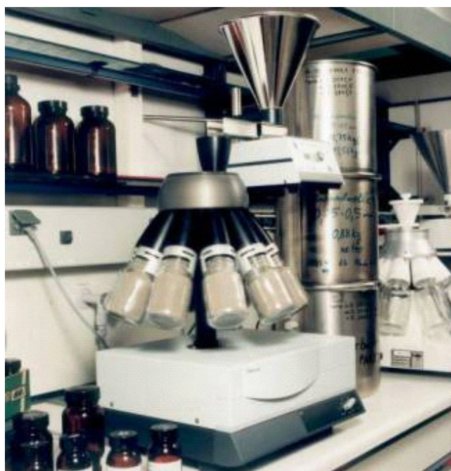
Abb. 8 Rotierender Probenteiler (8 Fallrohre)
