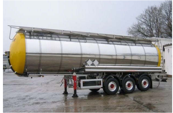
Abb. 78: Straßentankfahrzeug aus dem Werkstoff 1.4562 im Bau (links) und nach Fertigstellung (rechts)
