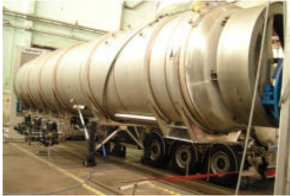
Abb. 78: Straßentankfahrzeug aus dem Werkstoff 1.4562 im Bau (links) und nach Fertigstellung (rechts)
