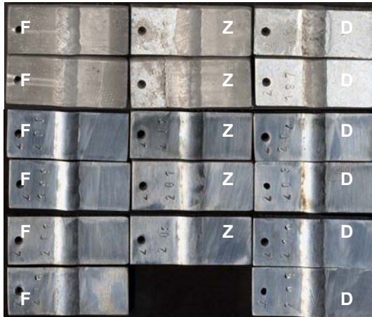
Abb. 32: Prüfbleche aus 1.4562 nach Auslagerung in der Monochloressigsäureschmelze bei 110 °C (oben) sowie in 70%iger (Mitte) und 0,1%iger (unten) Monochloressigsäure bei 55 °C (F...Flüssig-, Z...Zwischen-, D...Dampfphase)
