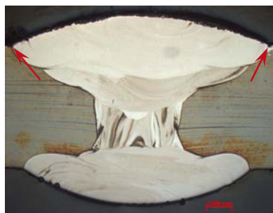
Abb. 70: Querschliff durch den Schweißnahtbereich eines Prüfbleches aus 1.4562 mit Anzeichen von Unregelmäßigkeiten (Beispiele markiert)
