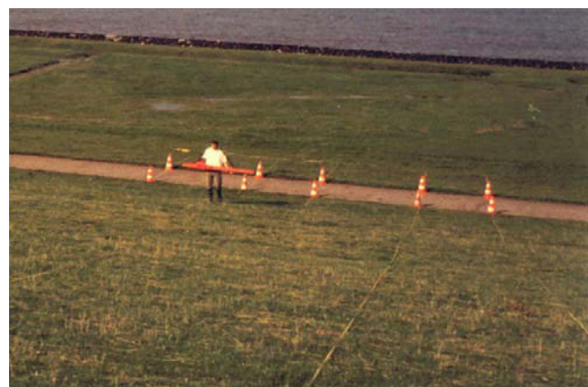
(b) Induktionselektromagnetik (BfG Lorenz) auf einem Flussdeich
