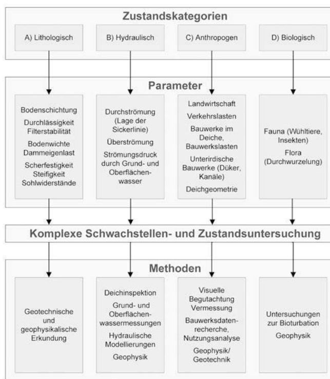
Abbildung 2.3.2 Übersicht über Zustandskategorien und Methoden zur Erfassung von Schwachstellen und Deichzustand
