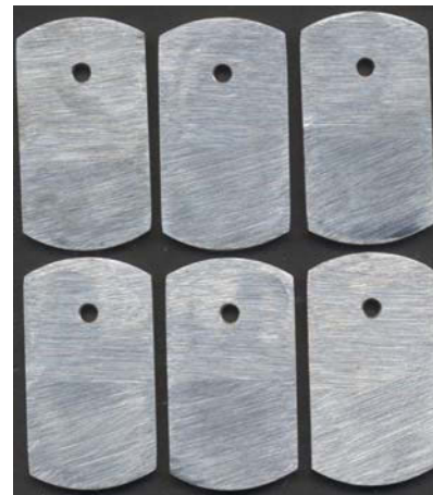
Abb. 2: Prüfkörperoberflächen vor Auslagerung
