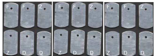
Abb. 8: Prüfkörperoberflächen des Stangenmaterials nach Auslagerung in konzentrierter Essigsäure bei 30 °C nach 7 (links), 14 (Mitte) und 28 (rechts) Tagen (F...Flüssig-, Z...Zwischen-, D...Dampfphase)
