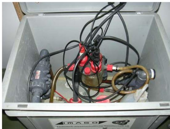
Abbildung 14: Durchflussmesszelle, IMAGO GbR
