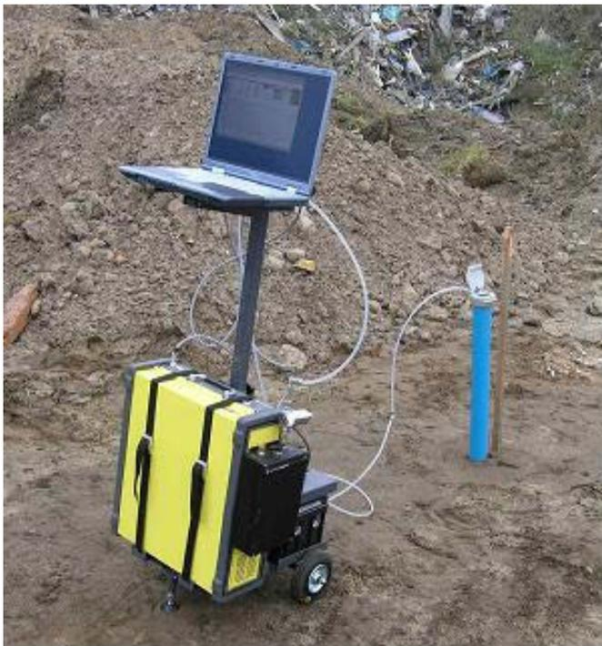
Abb. 31 Messung der Volumenkonzentrationen von Deponiegasbestandteilen mittels FTIR-Spektrometer an einem Pegelrohr auf dem Zwischenlager Altrupp
