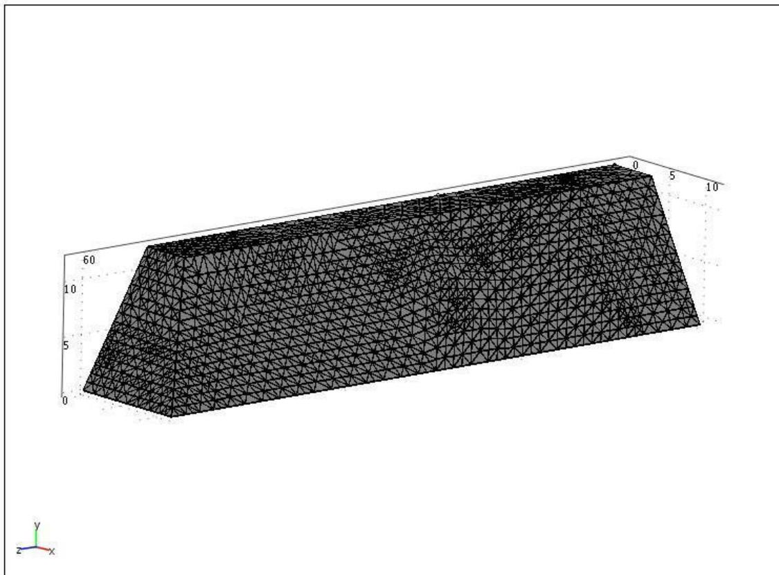
Abb. 21. Finite-Elemente-Netz der Beispielhalde, bestehend aus etwa 122 200 Elementen
