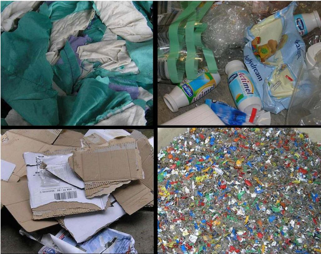
Abb. 3 brennbare Komponenten der verwendeten Fraktionen im Anlieferungszustand, von oben links im Uhrzeigersinn: Textilabfälle (für Fraktionen 2 und 7), ungereinigte Plastikabfälle (für Fraktion 8), Abfall aus der MBA (für Fraktion 9), Papier und Pappe (für Fraktion 1)
