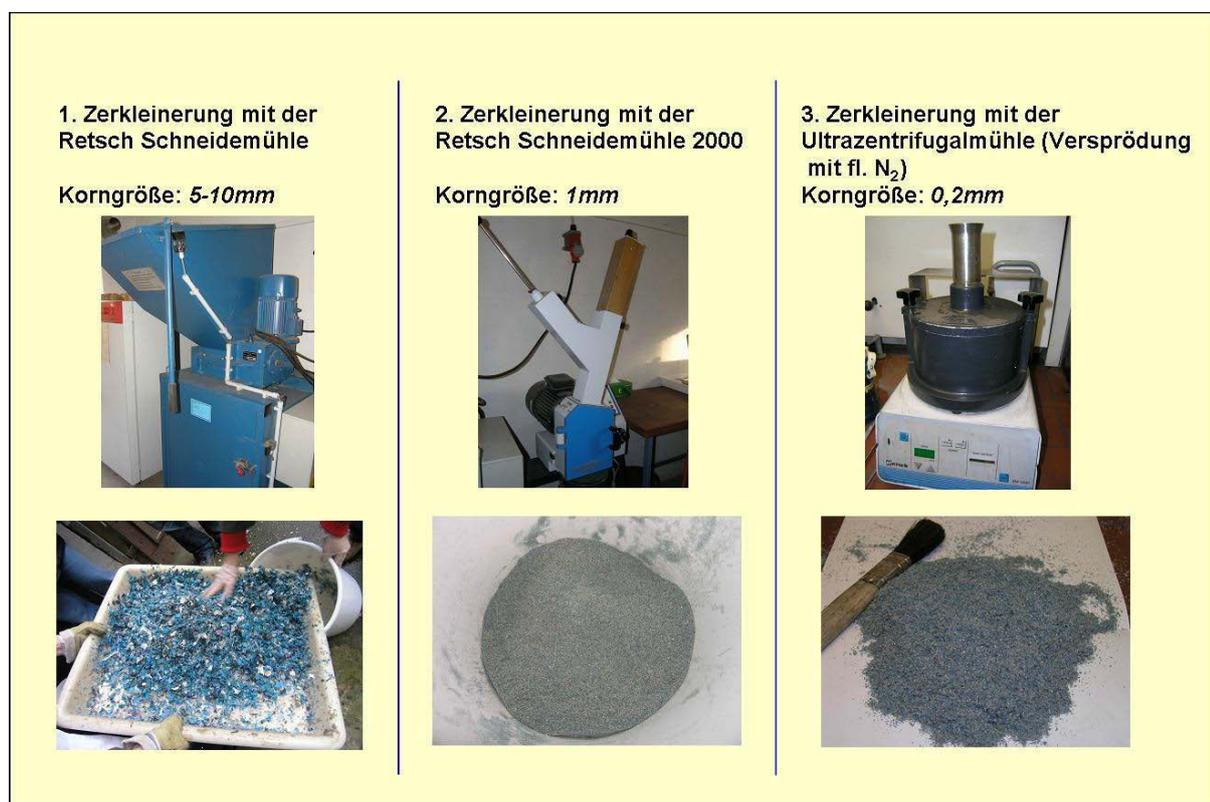
Abb. 9: Schrittweise Zerkleinerung der Abfallproben zur Aufbereitung für Warmlagerversuche nach DIN EN 15188
