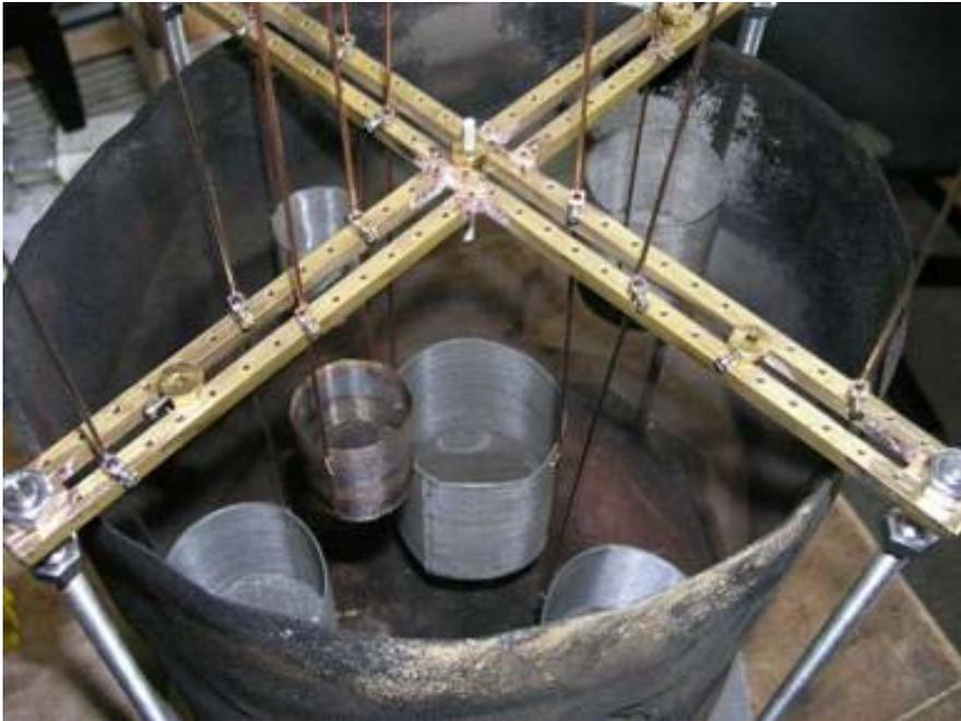
Abb. 6 Anordnung zur Untersuchung der Brandausbreitung bei inhomogener Verteilung der brennbaren Komponente
