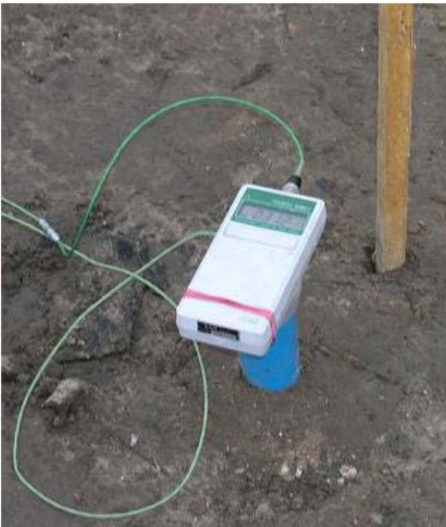
Abb. 32 Temperaturmessung im Pegelrohr mittels Thermoelement
