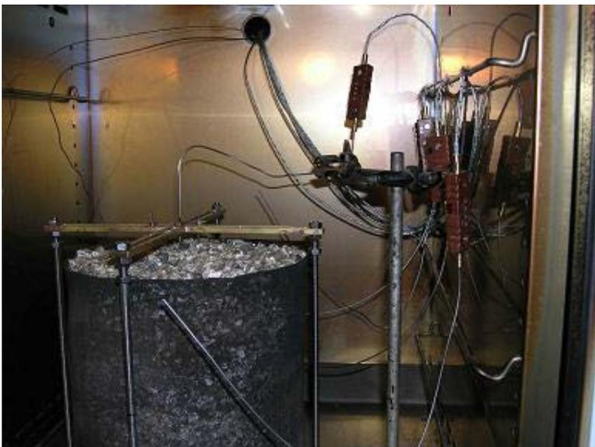
Abb.7 Versuchsanordnung aus Abb. 6 im Warmlagerungssofen nach Einbringen der nicht-brennbaren Komponente und Instrumentierung mit Thermoelementen
