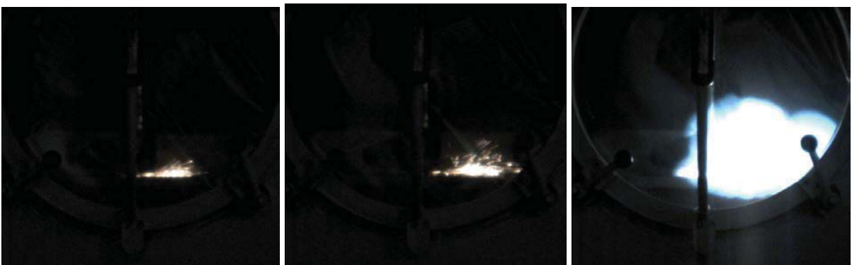
Abb. 17: Entwicklung eines Funkenregens nach einem Schlagvorgang zwischen unlegiertem Stahl, W = 80 \text{ Nm} , 8,0 Vol.-% Acetylen/Luft-Gemisch: Erzeugung der Partikel durch Abtrennvorgang, Beginn der Oxidation, Zündung des Gemisches durch mehrere Partikel, deren Wärmefelder sich überlagern
