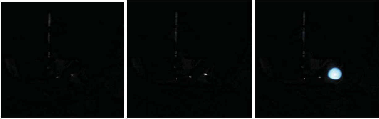
Abb. 15: Entwicklung einzelner (max. bis 3 bis 5) Partikel nach einem Schlagvorgang zwischen unlegiertem Stahl, W = 31 \text{ Nm} , 8,0 Vol.-% Acetylen/Luft-Gemisch: Erzeugung der Partikel durch Abtrennvorgang, Beginn der Oxidation - einzelner Partikel, einige Partikel verglühen nach der Oxidation ohne Zündwirkung, Zündung des Gemisches durch einen einzelnen Partikel
