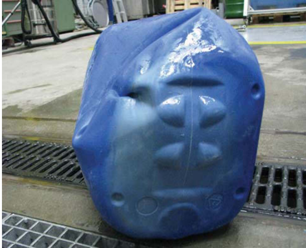
Abb. 4: Schadensbild der 22 l-Kanister
