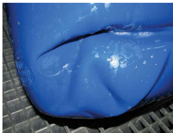
Abb. 11: Schadensbild eines 22 I-Kanisters nach 21-tägiger Vorlagerung mit 55 %-iger Salpetersäure und Fallprüfung bei -18 °C
