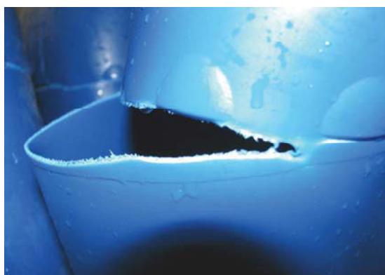
Abb. 13: Schadensbild eines 22 l-Kanisters nach 84-tägiger Vorlagerung mit 55 %-iger Salpetersäure und Fallprüfung bei -18 °C
