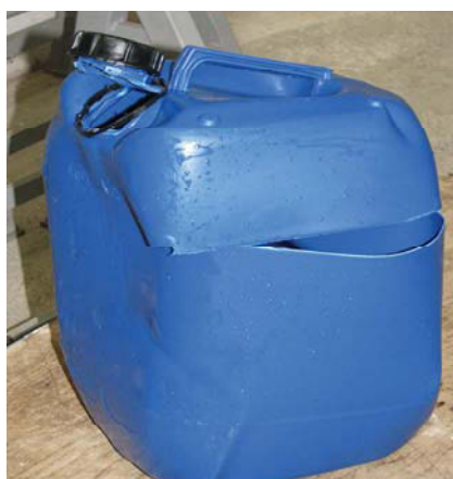
Abb. 12: Schadensbild eines 22 l-Kanisters nach 42-tägiger Vorlagerung mit 55 %-iger Salpetersäure und Fallprüfung bei -18 °C
