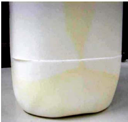
Abb. 9: Schadensbild eines 20 I-Kanisters nach 21-tägiger Vorlagerung mit 55 %-iger Salpetersäure und Fallprüfung bei -18 °C
