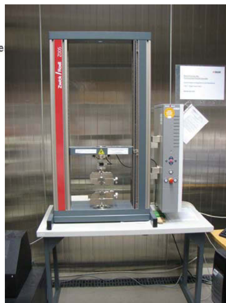
Abb. 8: Zugprüfeinrichtung vom Typ Zwick Z 005 inks und Probekörper (rechts)
