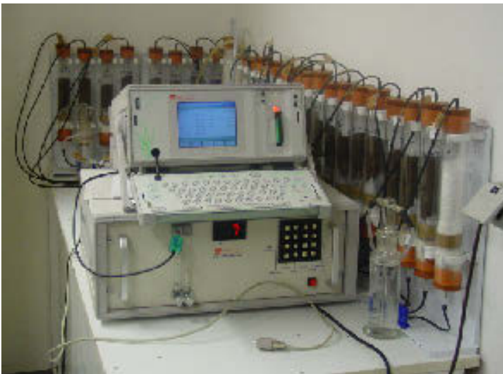
Abbildung 4.31: Aufbau zur Messung der Bodenatmungskurven mit der Gaseinheit und dem 2250 GAS Analyser (FA ADC)
