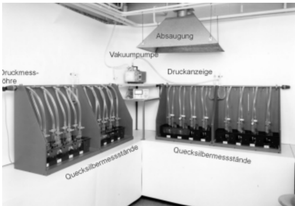
Bild 2.16: Wasserstoffbestimmung mittels Quecksilber-Methode in der BAM
