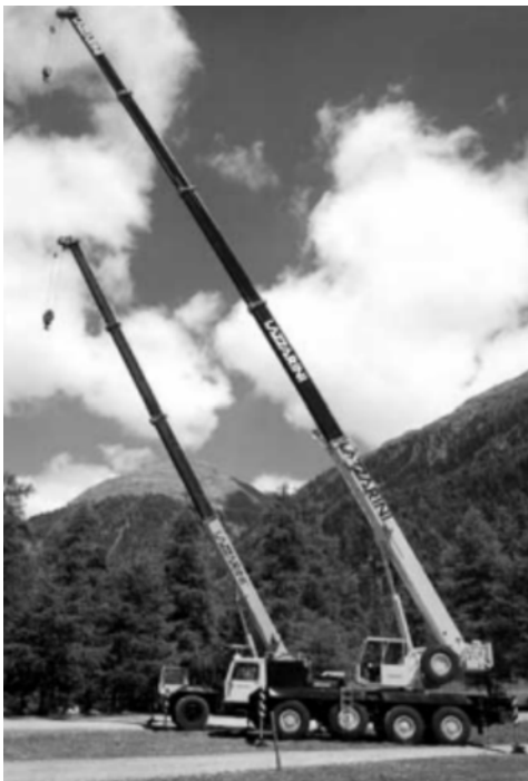
Bild 2.4: Einsatzbeispiel für höchstfeste Feinkornbaustähle im Automobilkranbau [49]
