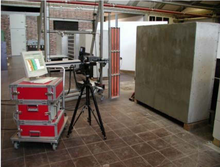
Abbildung 4.1 Experimenteller Aufbau für die Impuls-Thermografie im Bauwesen
