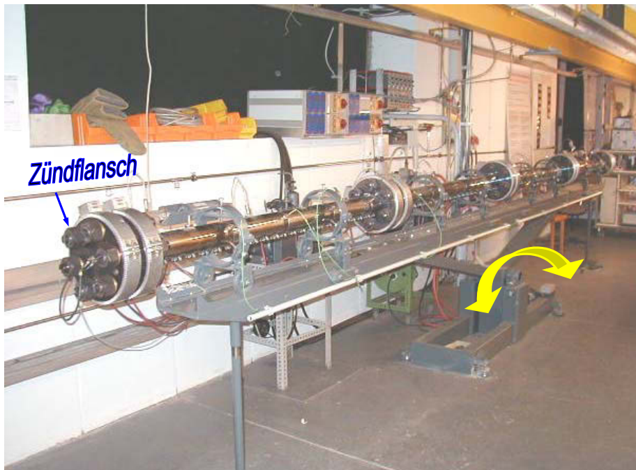
Bild 7-2: Apparatur zur Bestimmung des Explosionsverhaltens von Gasen und Dämpfen
