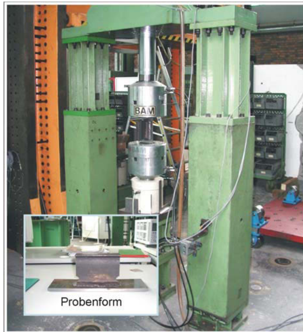
Bild 6–25: 400 kN - Versuchsstand mit eingebauter Laborprobe
