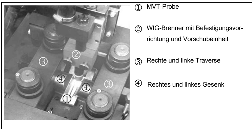
Bild 42: Der MVT - Test während einer Heißrissprüfung
