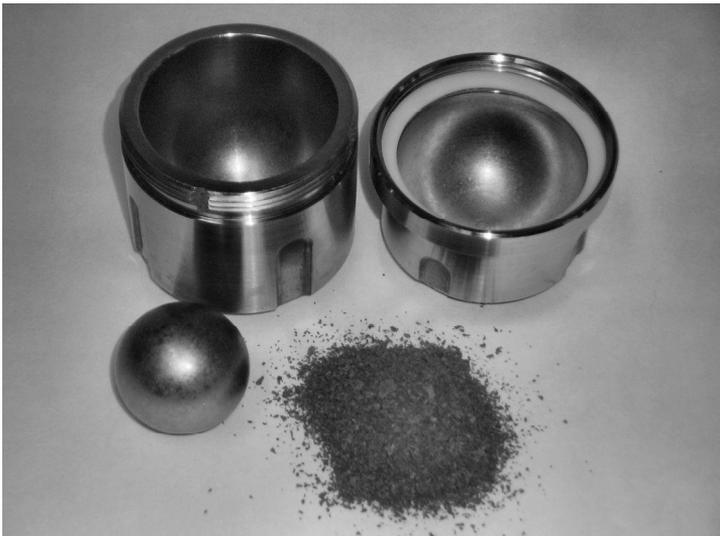
Abb. 9.3: Zerkleinerung und Homogenisierung der Probe in der Schwingmühle
