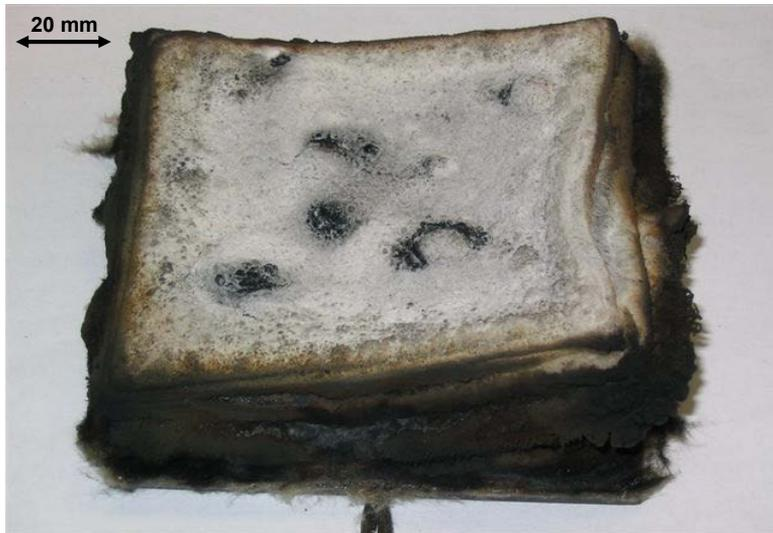
**Bild 5.5.10** Rückstand einer 12,5 mm Probe aus einer Untersuchung im Cone Calorimeter bei  $60 \text{ kW m}^{-2}$
