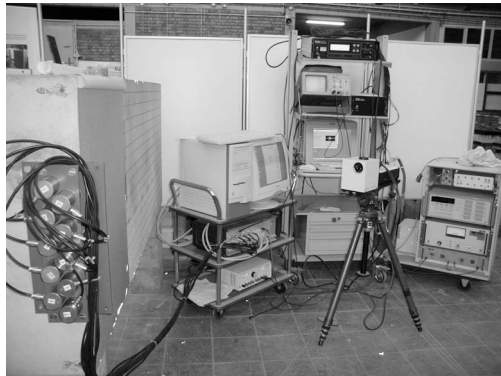
Abb. 59: Messapparatur mit Laservibrometer zur Visualisierung der Wellenausbreitung.
