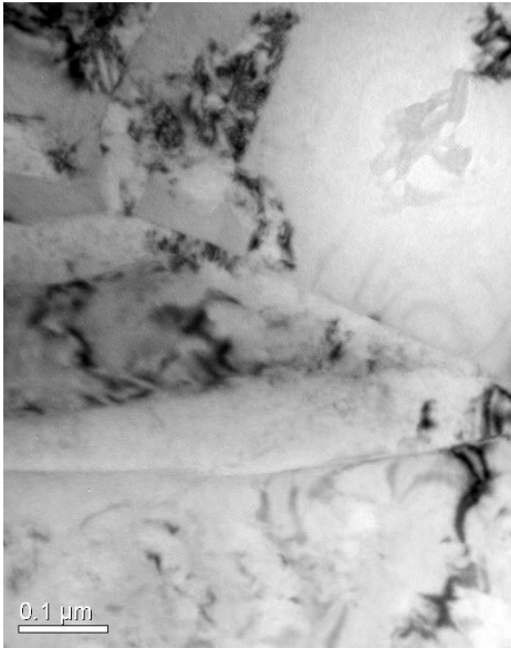
Bild 3.116: TEM WB200 2%. Scharf ausgeprägte Korngrenzen.
