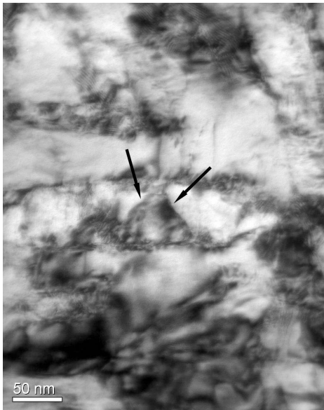
Bild 3.90: TEM WBRT 1300MPa. \alpha_s -Korn mit Subkorn Grenzen (Pfeile).
