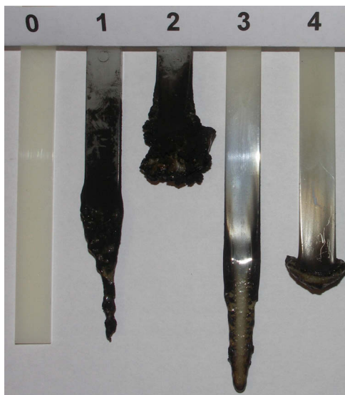
Abbildung 4.11 Typische Probenstäbe (3 mm) nach dem UL 94 V-Test (0 = Originalgröße aller Probenstäbe, 1 = PC/ABS, 2 = PC/ABS PTFE , 3 = PC/ABS/BDP, 4 = PC/ABS PTFE BDP)
