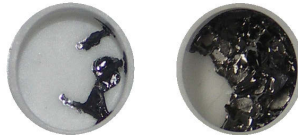
Abbildung 8.6 Rückstände von TG-Messungen, im Tiegel fotografiert nach erfolgter Messung bei 1 \text{ Kmin}^{-1} . Links: PC/ABS PTFE BDP Talk , rechts: PC/ABS PTFE BDP
