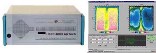
Abbildung 4.5 „USPC 4000 AirTech“ vom Ing. Büro Dr. W. Hillger: Industrie-PC mit PC-Karten (links), Steuersoftware „Hillgus for Windows“ (rechts), Bild entnommen aus [38]
