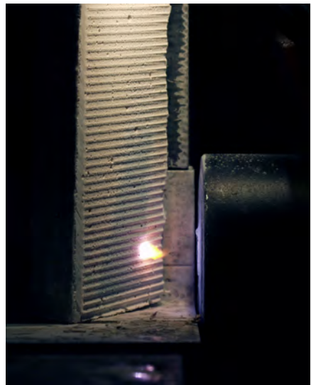
Abbildung 11: Plasmazündung auf einer Zementsteinoberfläche
