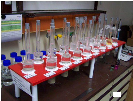
Abbildung 67 : Probenbeaufschlagung durch Zufuhrlösungen
