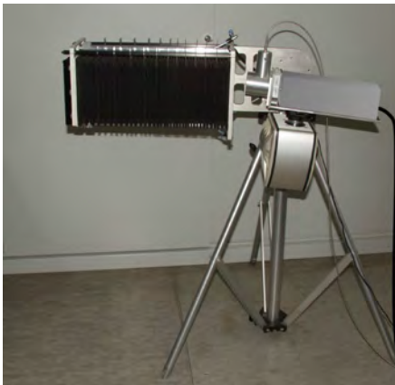
Abbildung 121: Mobiles LIBS-Gerät Demonstrator II für Messungen am Bauwerk (Forschungsprojekt ILCOM)
