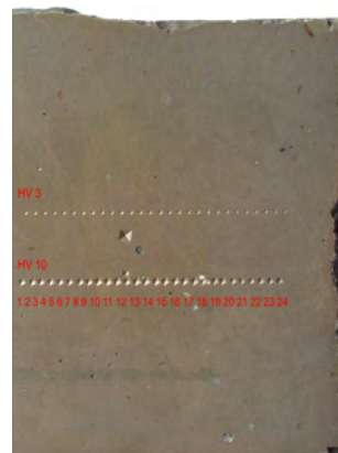
Abbildung 103: Probenoberfläche nach Härteprüfung
