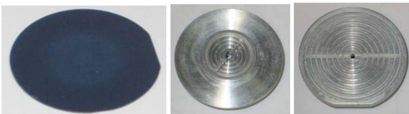
Abbildung 6.7: links: Foto eines mit MgF 2 beschichteten 2 Zoll Siliciumwafers; Mitte: Foto des herkömmlichen Spin-Coating Tellers; rechts: Foto des verbesserten Spin-Coating Tellers
