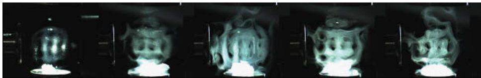
Abb. 13 Trockeneisversuche mit zwei gekreuzten Ultraschallfallen.
