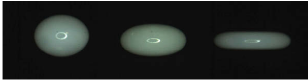
Abb. 10 Suspendierte Siliciumcarbid-Partikel verschiedener Tropfenformen durch variierten Schallpegel.
