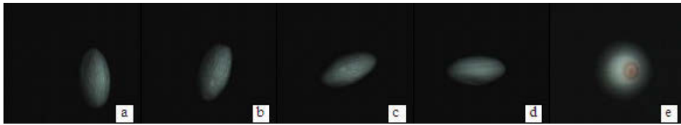
Abb. 16 Drehung der Rotationsachse eines rotationsellipsoidalen Styroporbällchens.
