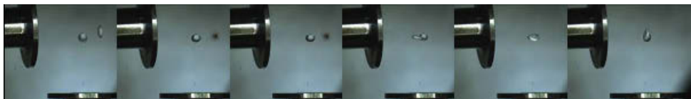
Abb. 18 Vereinigung von Styroporkugel mit Wassertropfen in gekreuzten Ultraschallfeldern.
