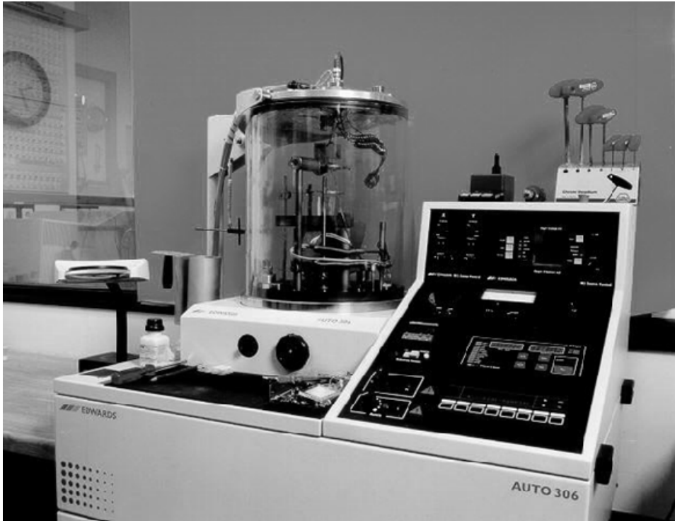
Abbildung 20: Edwards Bedampfungseinheit. Quelle: www.gsi.de .
