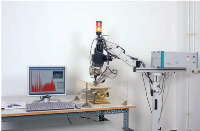
Abbildung A.1.: Foto des MikroTAX/ArtTAX-Spektrometers. In der Bildmitte ist der Messkopf mit dem leicht gekippt montierten Detektor (grau) und die in die Bildebene zeigende Röntgenröhre zu erkennen. Diese gesamte Einheit ist unterhalb der x-y-z-Verstelleinheit (schwarz) befestigt, die wiederum am Auslegerarm des Stativs (rechts) hängt. Auf dem Stativ selbst ist die Elektronikinheit befestigt, die zur Ansteuerung, Auslesung und Versorgung von Röhre, Detektor und Schrittmotoren dient und Schnittstellen zum PC bereitstellt.
