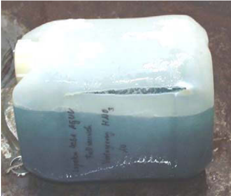
Abb. 55: Schadensbild eines 6 l-Kanisters nach Vorlagerung mit 55%iger Salpetersäure und Fallprüfung
