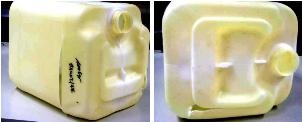
Abb. 58: Schadensbilder der 22 l-Kanister (Baumuster 2) aus dem Formstoff B (links) und dem Formstoff D (rechts) nach der Fallprüfung
