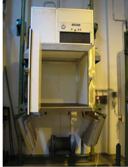
Abb. 45: Fallprüfeinrichtung mit Kühlschrank
