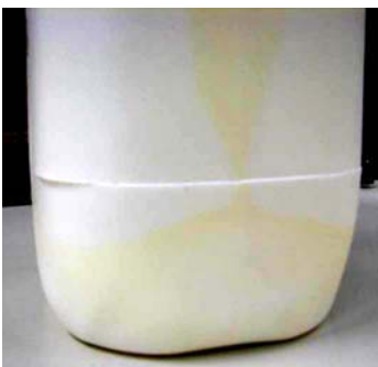
Abb. 56: Schadensbild eines 20 l-Kanisters nach 21-tägiger Vorlagerung mit 55%iger Salpetersäure und Fallprüfung
