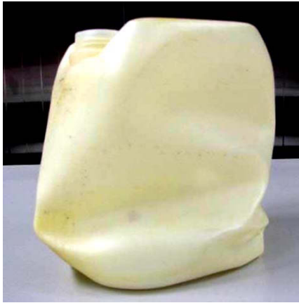
Abb. 52: Schadensbild eines 6 l-Kanisters nach der Stapeldruckprüfung mit 55%iger Salpetersäure
