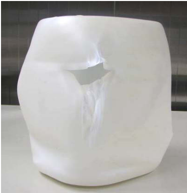
Abb. 60: Schadensbild eines nicht vorbelasteten 20 l-Kanisters nach Kompressionsprüfung
