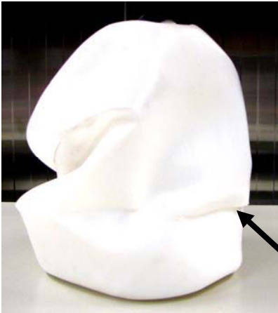
Abb. 51: Schadensbild eines 20 l-Kanisters nach der Stapeldruckprüfung mit n-Butylacetat gesättigter Netzmittellösung
