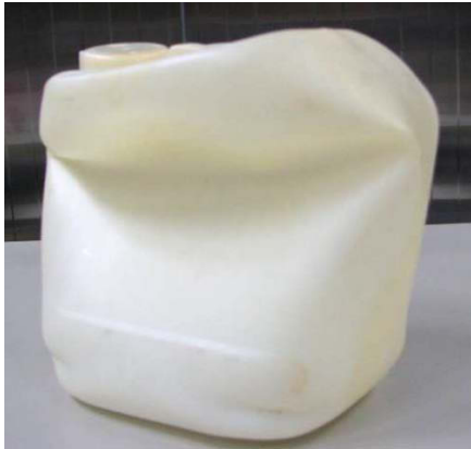
Abb. 48: Schadensbild eines 6 l-Kanisters nach der Stapeldruckprüfung mit 5%iger Netzmittellösung
