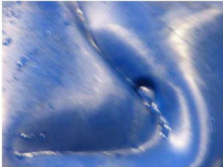
Abb. 54: Schadensbild eines 22 l-Kanisters (Baumuster 1) nach der Fallprüfung ohne Vorlagerung
