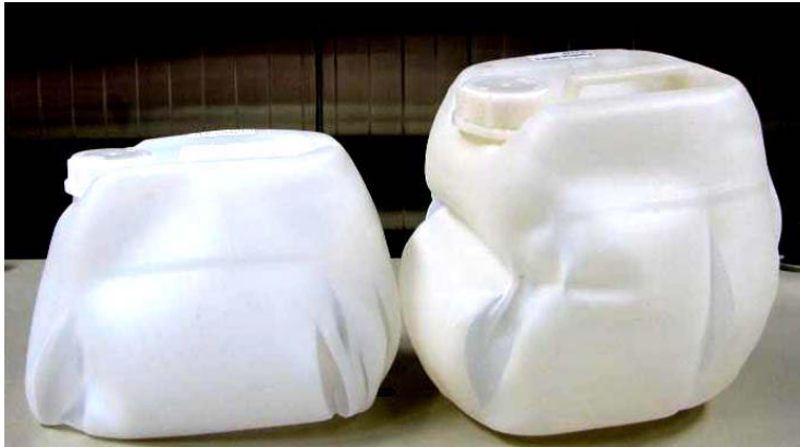
Abb. 59: Schadensbild eines nicht vorgelagerten 6 l-Kanisters (links) und eines mit 55%iger Salpetersäure vorgelagerten 6 l-Kanisters (rechts) nach Kompressionsprüfungen
