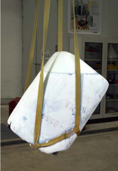
Abb. 44: Fallprüfeinrichtung mit 22 l-Kanister in Haltevorrichtung
