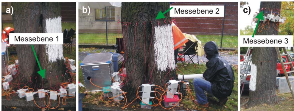
Abbildung 6.16: Eiche Nr. 3 - Pilzbefall: Fotos des Messaufbaus. Die Messungen fanden in drei Ebenen mit dem SIP-Verfahren und dem Bohrwiderstandsverfahren statt.
